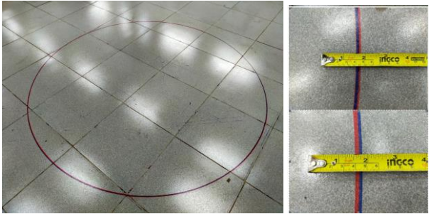
Hình 8.6: Kiểm tra độ chính xác với quỹ đạo hình tròn
